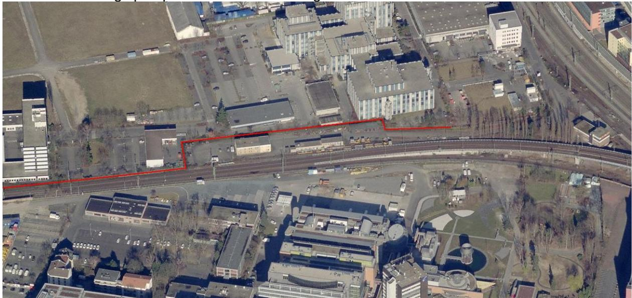
Die Höhe der Lärmschutzwand wurde mit einer Höhe von 2,0 m über Schienenoberkante (SOK), womit die Effektivhöhe der Wand außerhalb des Gleiskörpers ca. 2,5m (bei ebenem Verlauf) und ca. 3,5 – 4,0m an deren östlichen Ende entspricht.
