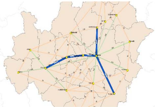
Abbildung des Knoten-Kanten-Modell mit Potenzial Radpendelnde auf den einzelnen Abschnitten
